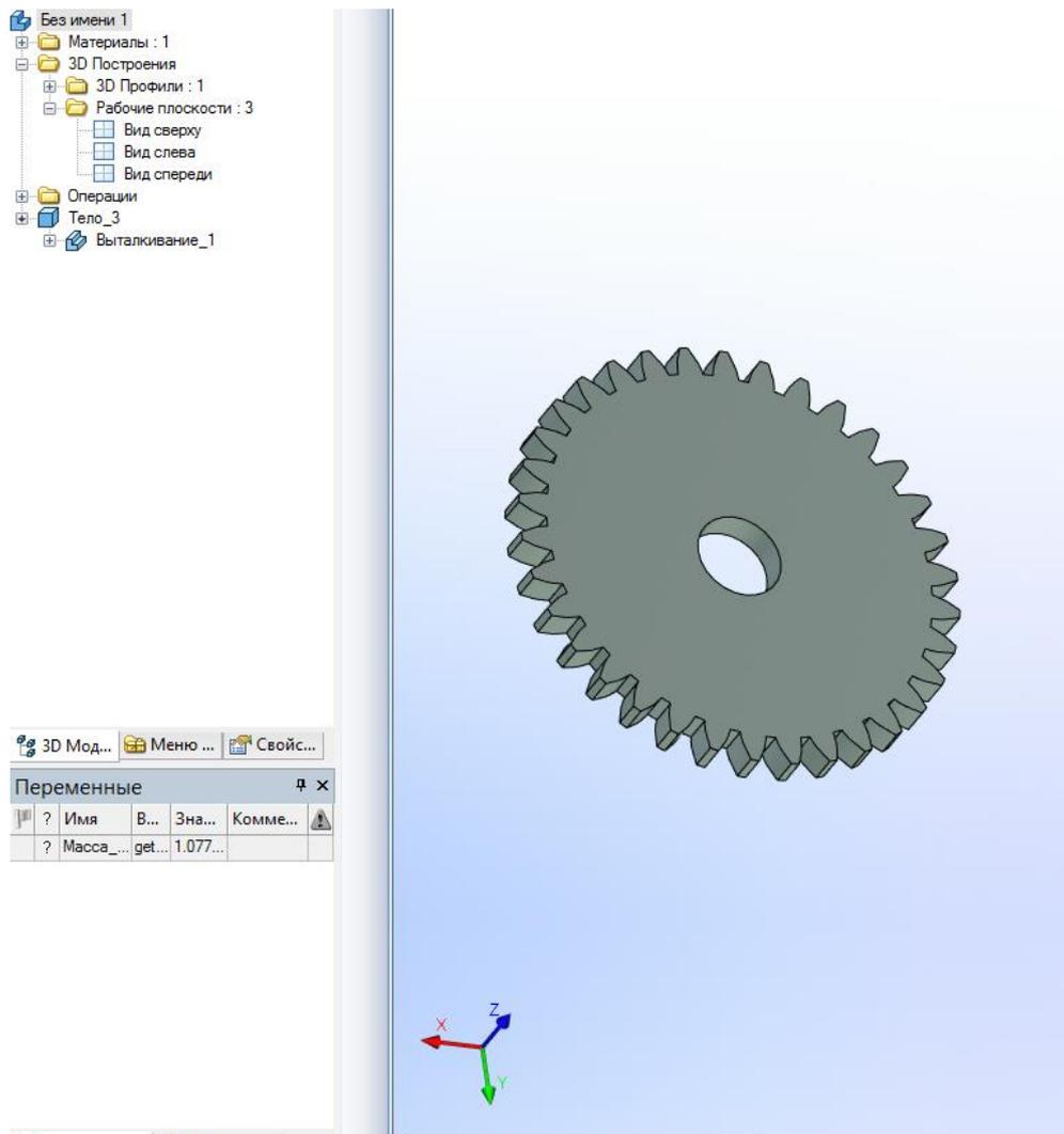
Как можно увидеть в дереве 3D модели, зубчатое колесо — это объемное тело, полученное с помощью одной операции – «Выталкивание».
