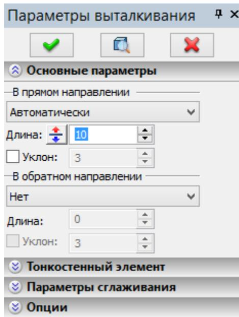
Чтобы изменить толщину зубчатого колеса, необходимо изменить значение параметра «Длина». После внесения изменений нажмите кнопку ОК и кнопку «Пересчитать 3D модель».
