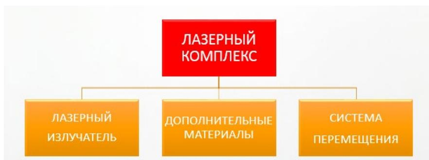
Лазерный излучатель — как он работает? Очень просто. У вас есть активное тело, которое генерирует фотоны. Фотоны превращаются в лазерное излучение. Мы создаем специальные условия с помощью 2-х зеркал для того, чтобы вдоль одного направления шла генерация фотонов. Сгенерированные фотоны, проходя через активное тело, усиливаются, и из каждого фотона получаются 2 фотона. Таким образом вдоль этого направления внутри активного тела происходит усиление:
